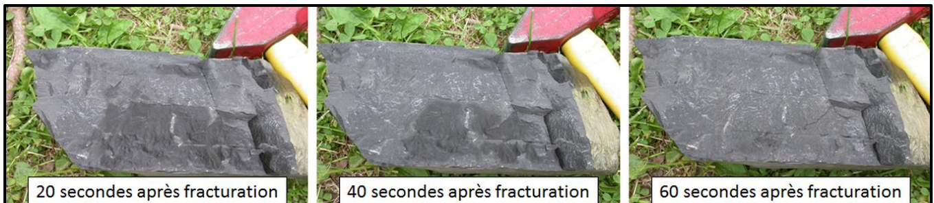
Figure 2. Aspect de la roche calcaire lorsqu'on la casse, 20, 40 et 60 secondes après la fracturation
